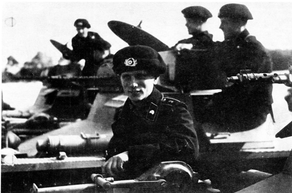
Pz.I Ausf.A и немецкие танкисты крупным планом. Танки модификации А легко идентифицировать (даже в том случае, когда не видно ходовой части и моторного отделения) по размещению домкрата и огнетушителя в передней части надгусеничных полок. Танкист на переднем плане опирается на домкрат; за его спиной, на соседней машине, виден огнетушитель.
