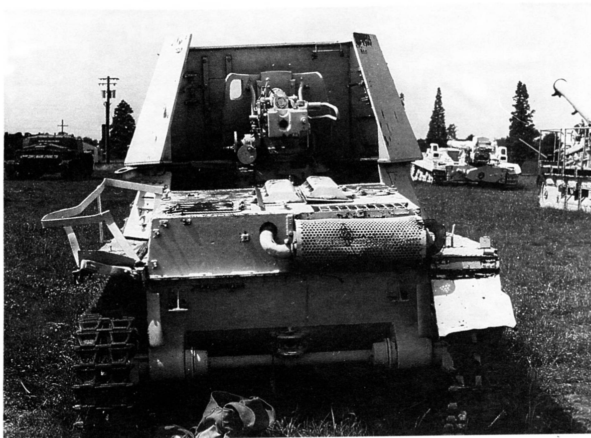
САУ Panzerjäger I в экспозиции танкового музея на Абердинском полигоне в США. На снимке хорошо виден внутренний подвижный щит пушки. На бортах рубки — клипсы для размещения снарядов. Большая часть боекомплекта находилась в корпусе, справа от механика-водителя.
